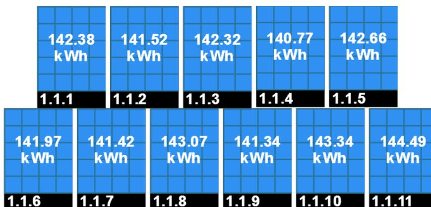
Figura 2 Produzione totale di ciascun modulo grazie agli ottimizzatori di potenza
